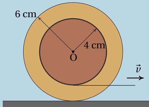
(a) Como a roda não derrapa, a velocidade do ponto B na figura ao lado é nula. Como tal, a velocidade  $\vec{v}_{A/B}$  de A relativa a B, é  $\vec{v}_A - \vec{v}_B = \vec{v}_A$ . Escolhendo o sistema de eixos indicado na figura e distâncias em centímetros, a velocidade do ponto A, que é a mesma velocidade com que a corda está a ser puxada no ponto C, é igual a:
