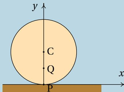
(a) Como a velocidade do ponto P é nula, a velocidade de C relativa a P é igual a 2 m/s e a velocidade angular da roda é
