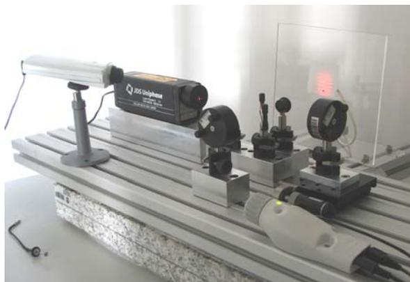
Figura 3. Interferómetro de Michelson – montagem experimental.
