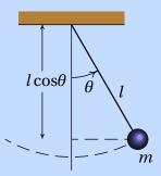
**Resolução**. A força de resistência do ar é proporcional ao quadrado da velocidade do pêndulo, e na direção oposta a essa velocidade (ver equação 4.14 do capitulo 4). Como a velocidade do pêndulo é igual a  $l\dot{\theta}$ , a expressão para a força de resistência do ar é:
