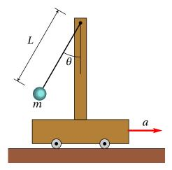
**Resolução.** A velocidade do carrinho será sempre horizontal e com módulo at, onde t é o tempo a partir do instante em que a velocidade do carrinho era nula. A figura à direita mostra a velocidade  $v_{e/c}$  da esfera, em relação ao carrinho, no caso em que  $\dot{\theta}$  é positiva. O módulo de  $v_{e/c}$  é igual a  $L\dot{\theta}$  e usando um sistema de eixos com x na direção e sentido de  $\ddot{a}$  e y na vertical e
