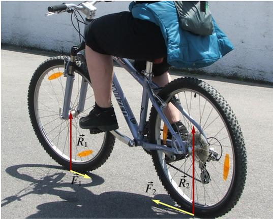
**Figura 4.7.:** Forças exercidas pela estrada nos pneus de uma bicicleta em movimento.
