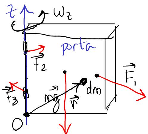
as dobradiças exercem forças e binários que eliminam qualquer movimento exeto rotação à volta do eixo z.
