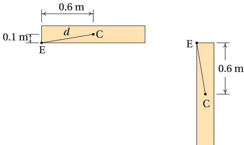
Como a velocidade do ponto E é nula, a velocidade do centro de massa é  $v_C = d\omega$ , onde  $\omega$  é a velocidade angular da tampa. O momento de inércia, em torno do eixo perpendicular à figura, passando pelo centro de massa C, é dado pela expressão para um paralelepípedo na tabela 5.1:
