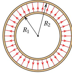
**Figura 4.6.:** Condensador esférico.
