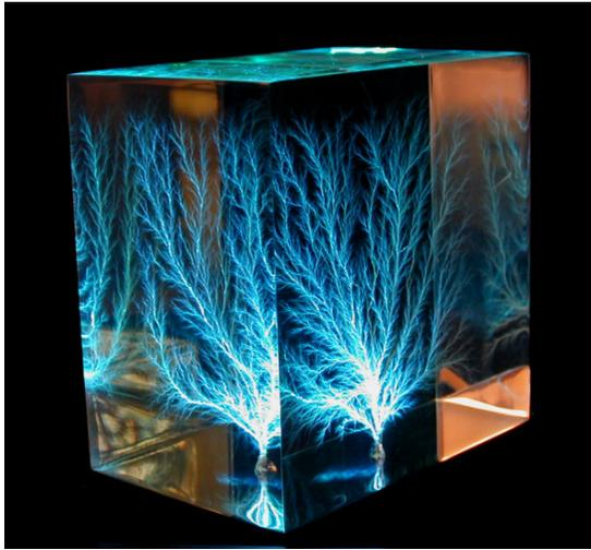
**Figura 4.4.:** Bloco de acrílico após a rutura do dielétrico.
