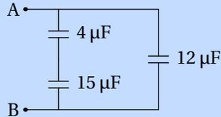
**Resolução.** Os condensadores de  $4 \mu\text{F}$  e  $15 \mu\text{F}$  encontram-se em série e, portanto, podem ser substituídos por um só condensador de capacidade:
