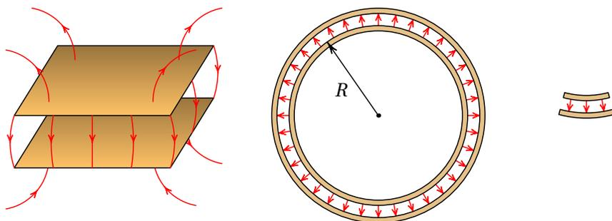
**Figura 4.7.:** Condensador plano, condensador esférico muito grande e uma pequena região que aproxima o condensador plano.
