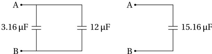
Nos dois condensadores de  $12 \mu\text{F}$  e  $3.16 \mu\text{F}$  a voltagem é a mesma e é igual a  $200$  V; assim sendo, as cargas nesses condensadores são:
