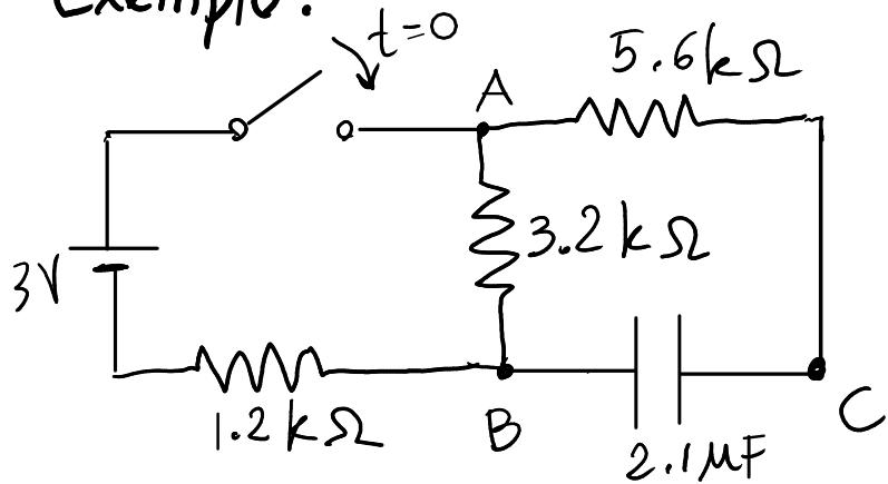
Em  $t=0$ , o condensador está descarregado e fecha-se o interruptor.
