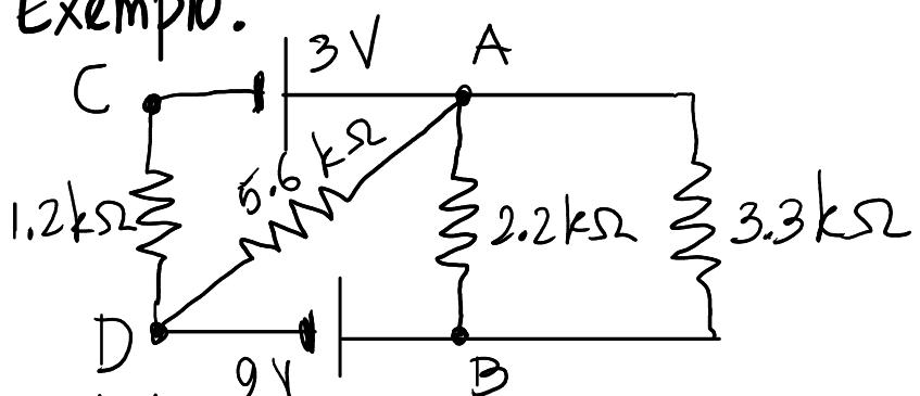
Determine a corrente e voltagem EM cada uma das resistências.
