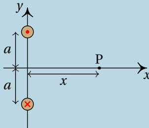
(a) No plano  $xy$ , as linhas do campo  $\vec{B}_1$  devido a fio de cima são circunferências com centro no fio, no sentido contrário aos ponteiros do relógio. No ponto P, o vetor  $\vec{B}_1$  é perpendicular ao segmento entre P e o fio, no sentido indicado na figura seguinte. As linhas do campo devido ao fio de baixo rodam no sentido dos ponteiros do relógio e no ponto P o campo  $\vec{B}_2$  é perpendicular ao segmento entre P e esse fio, como mostra a figura:
