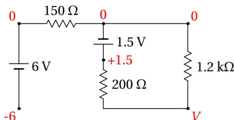
Observe-se que a corrente na resistência de  $150 \Omega$  é nula, porque não tem percurso por onde circular. Como tal, o potencial nos dois extremos dessa resistência é o mesmo e pode arbitrar-se que é nulo, como mostra o diagrama anterior. O potencial no elétrodo negativo da f.e.m. de  $6 \text{ V}$  será então igual a  $-6 \text{ V}$  e o potencial no elétrodo positivo da f.e.m. de  $1.5 \text{ V}$  será igual a  $1.5 \text{ V}$ .
