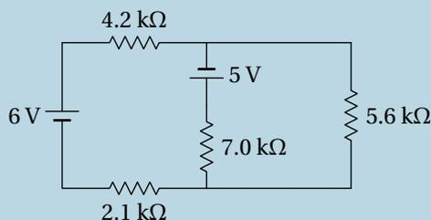
Usando unidades de  $k\Omega$  para as resistências e V para as voltagens, as correntes obtidas estarão em mA. Definem-se duas correntes de malha  $i_1$  e  $i_2$ , que podem ser no sentido dos ponteiros do relógio:
