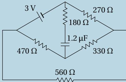
(a) O circuito equivalente no estado inicial, com o condensador em curto-circuito, é o seguinte
