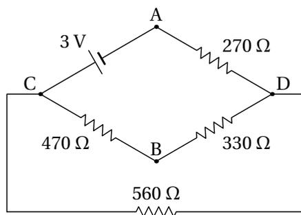
Onde as resistências de  $470 \Omega$  e  $330 \Omega$  estão em série entre C e D, e a resistência equivalente ficará em paralelo com a resistência de  $560 \Omega$ , conduzindo aos seguintes circuitos equivalentes mais simples:
