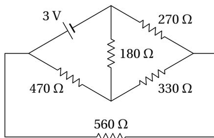
Usando o método das malhas, com três correntes de malha no sentido contrário aos ponteiros do relógio, o sistema de equações do circuito é então,
