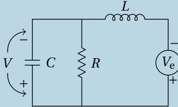
(a) O condensador e a resistência estão em paralelo e esse sistema está em série com o indutor; como tal, a impedância total é:
