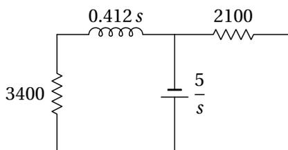
O indutor e a resistência de  $3.4 \text{ k}\Omega$  estão em série, podendo ser substituídos por um único dispositivo com impedância  $3400 + 0.412s$ . A transformada da corrente nesse dispositivo será:
