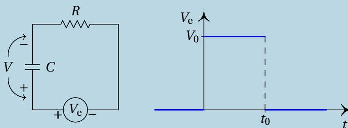
A impedância total é a soma das impedâncias da resistência e do condensador e a transformada da tensão de saída é igual à corrente vezes a impedância do condensador:
