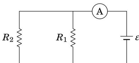
Registre o valor da corrente  $I$  indicado pelo amperímetro (corrente total). A seguir, ligue o amperímetro em série com cada uma das duas resistências, tal como nos dois lados da figura seguinte, e registre os valores das correntes  $I_1$  e  $I_2$  nas duas resistências.
