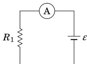
Antes de acender a fonte, peça ao docente que verifique a montagem, para evitar queimar o fusível do amperímetro! Registre o valor da intensidade da corrente, indicado pelo amperímetro, e meça a diferença de potencial na resistência com um voltímetro. Repita o procedimento, pelo menos 5 vezes, com diferentes valores da f.e.m.
