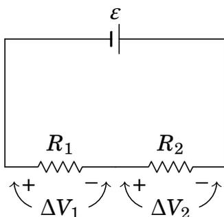
Com o voltímetro meça as voltagens  $\Delta V_1$  e  $\Delta V_2$  nas duas resistências e meça também a voltagem total  $\Delta V$  (pode ser medida entre os terminais da fonte).
