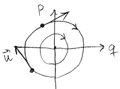
No plano de fase, o estado realiza movimento circular uniforme com velocidade angular  $\omega$  constante:  $\begin{cases} q = q_{\max} \cos \omega t \\ p = -q_{\max} \sin \omega t \end{cases}$
