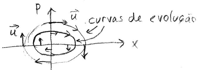
$$\text{Mudança de variável } q = \sqrt{mk}x \Rightarrow \begin{cases} \dot{q} = \sqrt{k/m} p \\ \vec{u} = (\omega p, -\omega q) , \omega = \sqrt{k/m} \end{cases}$$
