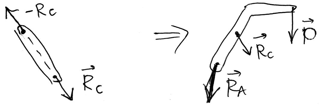
⇒ unicamente 3 variáveis:  $R_{Ax}$ ,  $R_{Ay}$ ,  ~~$R_{Ax}$ ,  $R_{Ay}$~~  e  $R_c$  (direcção de  $\vec{R}_c$  conhecida)
