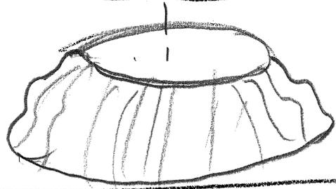
O volume do sólido de revolução é  $2\pi \bar{y} A$ , onde  $A$  é a área da figura plana e  $\bar{y}$  a distância do centróide ao eixo.
