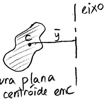
rodando a figura plana em relação ao eixo, obtém-se um sólido de revolução
