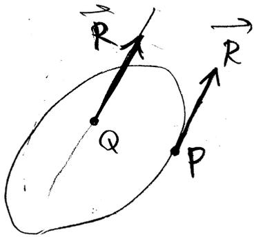
qualquer deslocamento paralelo da linha de ação de  $\vec{R}$ , introduz um momento perpendicular a  $\vec{R}$
