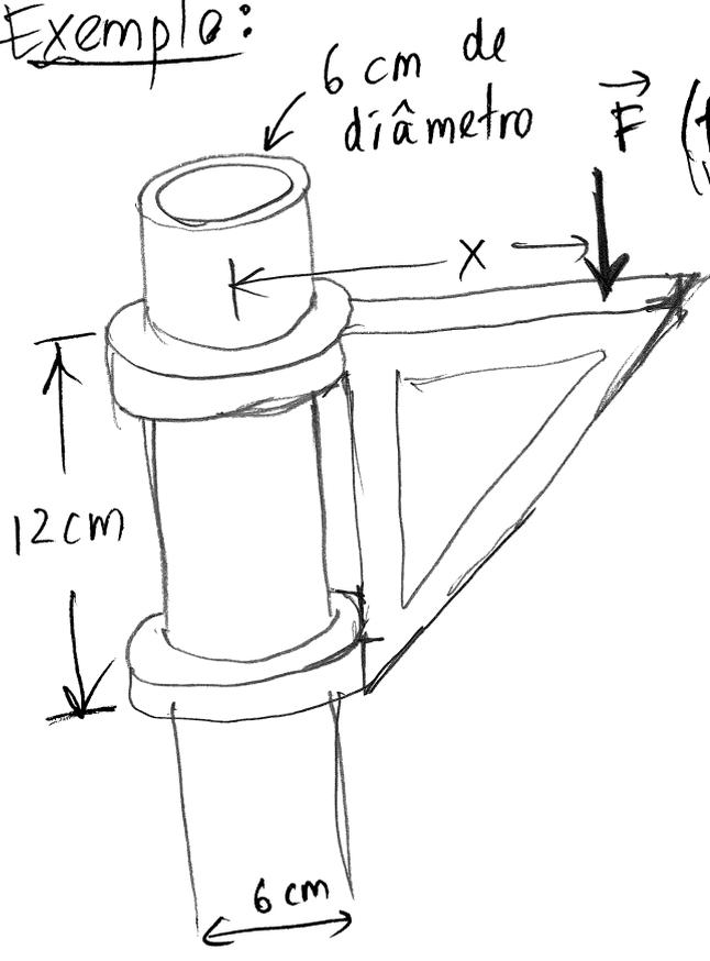
A peça móvel pode ser deslocada a qualquer altura no poste vertical. O coeficiente de atrito estático entre a peça e o poste é  $\frac{1}{2}$ . Calcule a distância mínima  $x$  à qual deverá actuar a força  $\vec{F}$  para a peça permanecer estática (o peso da peça é  $\ll F$ )
