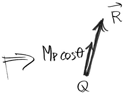
No ponto Q, o sistema equivalente é uma força  $\vec{R}$  e um momento na mesma direção. (TORSOR)
