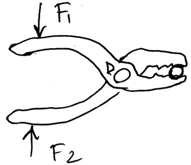
Para calcular as forças internas nos pontos A, B, C ou D, é necessário considerar por separado o diagrama de corpo livre de cada peça:
