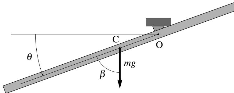
As forças que atuam no ponto O não foram representadas, porque trata-se de um movimento de rotação com eixo fixo e as forças no eixo não produzem momento em relação ao eixo. O momento resultante, em relação a O, será apenas o momento do peso e, portanto:
