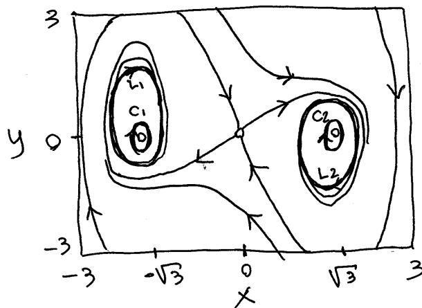
$C_1$  e  $C_2$  são dois dos ciclos que existem à volta de  $P_2$  e  $P_3$ . As duas curvas de evolução que saem do ponto de sela aproximam-se desses ciclos mas, como não se podem cruzar com eles, conclui-se que existem dois ciclos limite,  $L_1$  e  $L_2$  à volta de cada um dos pontos  $P_2$  e  $P_3$ .
