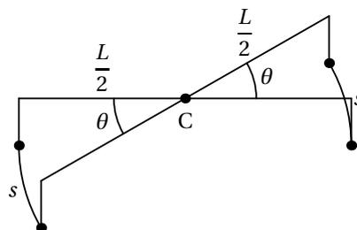
Como tal, o sistema tem um único grau de liberdade: basta usar  $\theta(t)$  ou  $s(t)$  para descrever o movimento de todo o sistema. Escolhendo  $s$ , as duas variáveis de estado serão  $s$  e  $v = \dot{s}$ , e existirá uma única equação de Lagrange.
