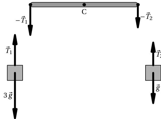
A barra terá aceleração angular  $\alpha$  no sentido contrário aos ponteiros do relógio. A aceleração do bloco do lado esquerdo será  $a = \alpha(L/2)$ , para baixo, e o bloco do lado direito terá a mesma aceleração  $a$ , mas para cima. Como tal, as equações de movimento dos 3 corpos são as seguintes:
