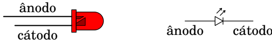
Figura 12.11.: LED e diagrama de circuito correspondente. O cátodo costuma ser um fio mais curto e estar perto de uma zona onde a cobertura plástica é plana.
