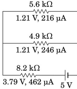
Finalmente, substitui-se a resistência de  $4.9 \text{ k}\Omega$  pelas resistências de  $2.7 \text{ k}\Omega$  e  $2.2 \text{ k}\Omega$ , recuperando-se o circuito original. Nessas duas resistências em série a corrente de  $246 \mu\text{A}$  será a mesma, e as diferenças de potencial obtêm-se multiplicando essa corrente pelos valores das duas resistências. A figura seguinte mostra a diferença de potencial e a corrente em todas as resistências do circuito original.
