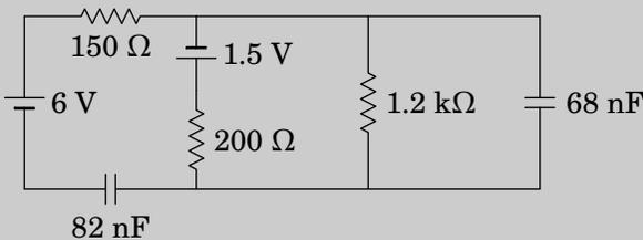
**Resolução.** (a) No instante inicial, em que os condensadores descarregados atuam como curto-circuitos, o circuito equivalente é o seguinte
