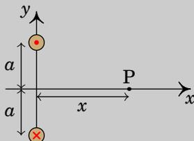
**Resolução.** (a) No plano  $xy$ , as linhas do campo  $\vec{B}_1$  devido a fio de cima são circunferências com centro no fio, no sentido contrário aos ponteiros do relógio. No ponto P, o vetor  $\vec{B}_1$  é perpendicular ao segmento entre P e o fio, no sentido indicado na figura seguinte. As linhas do campo devido ao fio de baixo rodam no sentido dos ponteiros do relógio e no ponto P o campo  $\vec{B}_2$  é perpendicular ao segmento entre P e esse fio, como mostra a figura:
