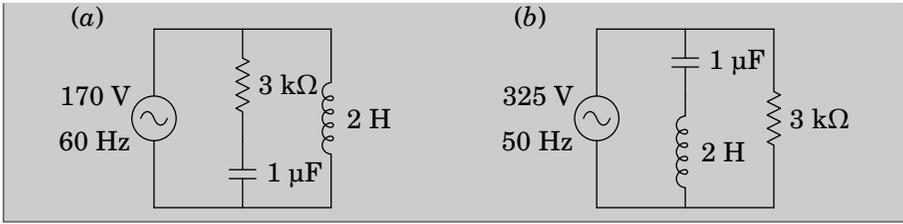
**Resolução.** (a) Usando unidades de  $k\Omega$  para as impedâncias, H para as indutâncias,  $\mu\text{F}$  para as capacidades, V para as voltagens e kHz para as frequências, a frequência angular da fonte e as impedâncias dos 3 elementos no circuito são as seguintes:
