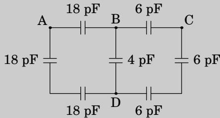
(a) Para determinar a capacidade entre B e D, imagine-se que é ligado entre esses dois pontos um medidor de capacidades, representado por F, na figura seguinte:
