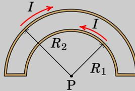
**Resolução.** Com plano  $xy$  no plano do fio e origem no ponto P, o vetor posição  $\vec{r}$  do ponto P é nulo. Nos dois segmentos retilíneos o vetor posição  $\vec{r}'$  de um ponto no segmento é na mesma direção da corrente e, como tal,
