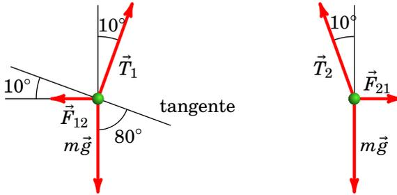
onde  $\vec{T}_1$  e  $\vec{T}_2$  são as tensões nos dois fios,  $\vec{F}_{12}$  é a força elétrica da esfera 2 sobre a esfera 1 e  $\vec{F}_{21}$  é a força elétrica da esfera 1 sobre a esfera 2.
