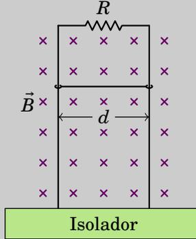
**Resolução.** Quando a barra já desceu uma distância  $y$  em relação à resistência  $R$ , a área da espira retangular formada pela barra, os trilhos e a resistência é  $A = yd$  e o fluxo magnético através dela é  $\Phi = Byd$ .
