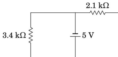
Ou seja, a voltagem na resistência de  $3.4 \text{ k}\Omega$  é igual a  $5 \text{ V}$ .
