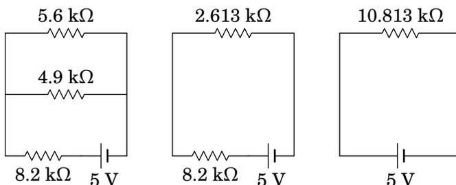
Com uma única resistência ligada à f.e.m. de  $5 \text{ V}$ , a diferença de potencial nessa resistência são  $5 \text{ V}$  e a corrente é:
