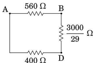
As resistências de  $400 \Omega$  e  $3000/29 \Omega$ , em série porque não há nada ligado em D, são equivalentes a  $14600/29 \Omega$
