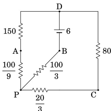
Combinam-se as resistências de 150 e 100/9, em série, e as resistências de 80 e 20/3, em série, ficando o circuito do lado esquerdo da seguinte figura. A seguir combinam-se as resistências de 1450/9 e 260/3, em paralelo, ficando o circuito do lado direito da figura seguinte:
