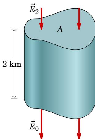
Na tampa de cima o campo elétrico,  $\vec{E}_2$ , tem módulo 66 N/C e aponta para dentro da superfície fechada. Como tal, nessa tampa há fluxo negativo igual a (unidades SI):
