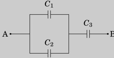
**Resolução.** Para resolver este tipo de problema, simplifica-se o circuito até ficar unicamente com um condensador. O primeiro passo é substituir os condensadores de capacidades  $C_1$  e  $C_2$ , que estão em paralelo, por um condensador equivalente com capacidade  $C_4$ . No segundo passo, os condensadores de capacidades  $C_4$  e  $C_3$ , que ficam ligados em série, são substituídos por um único condensador com capacidade  $C_5$ . A figura seguinte mostra esses passos.
