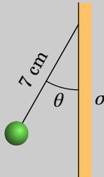
**Resolução.** O campo elétrico produzido pelo plano é horizontal, com módulo constante  $E = 2\pi k\sigma$ . A força elétrica sobre a carga pontual positiva é horizontal, para a esquerda, e com módulo (unidades SI):
