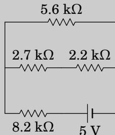
**Resolução.** As quatro resistências podem ser combinadas numa só, usando os três passos indicados na figura seguinte. Primeiro combinam-se as resistências de  $2.7 \text{ k}\Omega$  e  $2.2 \text{ k}\Omega$ , em série, a seguir a resultante combina-se, em paralelo, com a resistência de  $5.6 \text{ k}\Omega$  e a resultante combina-se em série com a resistência de  $8.2 \text{ k}\Omega$ .
