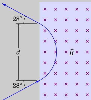
**Resolução.** Dentro do retângulo com campo magnético constante o movimento é circular uniforme com raio:
