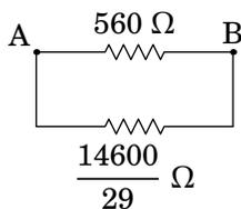
Essas duas resistências estão em paralelo, sendo a resistência equivalente entre A e B igual a:
