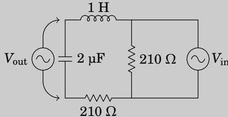
**Resolução.** Usando unidades de  $\mu\text{C}$  para a capacidade e H para a indutância, como  $LC = -Z_L/(Z_C\omega^2)$  tem unidades de tempo ao quadrado, então o tempo deverá ser medido em ms e a frequência em kHz. As impedâncias deverão então ser medidas em  $k\Omega$ . Nessas unidades, os valores das impedâncias das resistências, do indutor e do condensador no circuito, em função de  $\omega$ , são:
