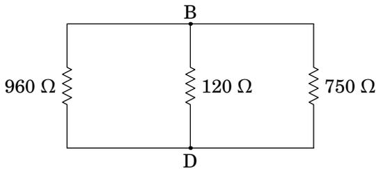
Cada uma das três resistências nesse circuito está ligada entre os pontos B e D. Como tal, as três resistências estão em paralelo e a resistência equivalente entre B e D é:
