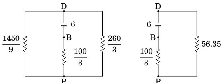
Arbitrando  $V_B = 0$ , o potencial do nó D será  $V_D = 6$  V. Por divisão de voltagem, no circuito do lado direito da figura acima, determina-se o potencial do ponto P:
