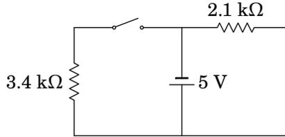
Como a corrente na resistência de  $3.4 \text{ k}\Omega$  é nula, a voltagem nela também é igual a zero.
