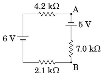
Trata-se de uma malha simples, com f.e.m. total de 11 V e corrente no sentido dos ponteiros do relógio. A diferença de potencial entre B e A é
