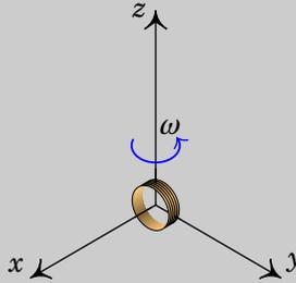
**Resolução.** A velocidade angular é igual à derivada do ângulo entre o eixo da bobina e o eixo dos  $x$ :  $d\theta/dt = \omega = 40$ . Como esse ângulo é igual a zero no instante  $t = 0$ , a expressão do ângulo em função do tempo é (unidades SI):
