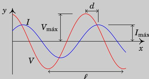
**Resolução.** O ângulo da impedância é igual à constante de fase da tensão menos a constante de fase da corrente:
