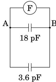
Finalmente, a capacidade entre os pontos A e B e a capacidade equivalente dos condensadores de 18 pF e 3.6 pF em paralelo:
