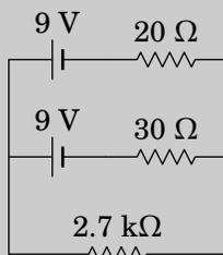
**Resolução.** (a) A f.e.m.  $V_{\text{th}}$  entre os pontos onde está ligada a resistência de  $2.7 \text{ k}\Omega$  é a diferença de potencial entre os pontos A e B no seguinte circuito:
