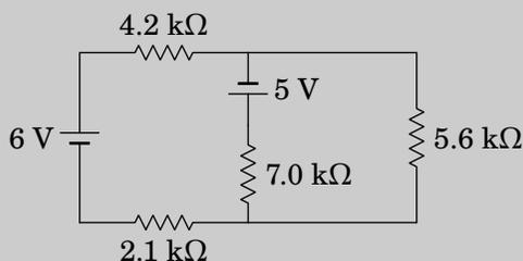
**Resolução.** Podemos determinar o equivalente de Thévenin entre os dois pontos onde está ligada a resistência de 5.6 kΩ. A f.e.m.  $V_{th}$  é a diferença de potencial entre os pontos A e B no seguinte circuito:
