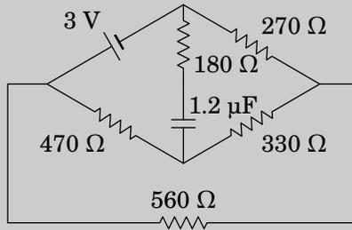
**Resolução.** (a) No estado inicial, com o condensador em curto-circuito, as resistências de  $180 \Omega$ ,  $270 \Omega$  e  $330 \Omega$  formam um delta, que pode ser substituído pelas seguintes três resistências em estrela:
