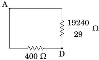
Finalmente, essas duas resistências estão em paralelo e a resistência equivalente entre A e D é:
