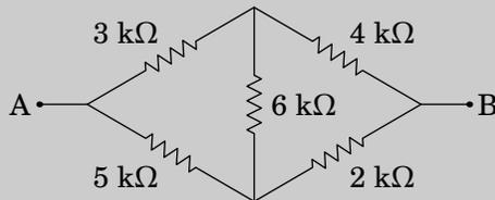
**Resolução.** Usando a transformação delta-estrela, o triângulo formado pelas resistências de 4 kΩ, 2 kΩ e 6 kΩ pode ser substituído pelas 3 resistências:
