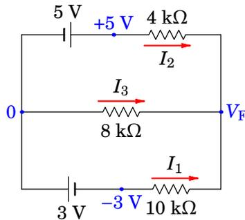
**Figura 6.7.:** Resolução do circuito 6.5 pelo método dos nós.
