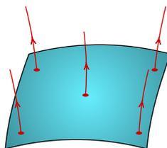
**Figura 3.3.:** Superfície equipotencial e linhas de campo, perpendiculares à superfície.
