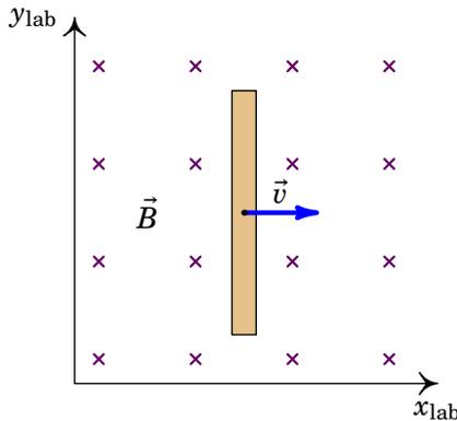
**Figura 9.1.:** Condutor em movimento num campo magnético uniforme.
