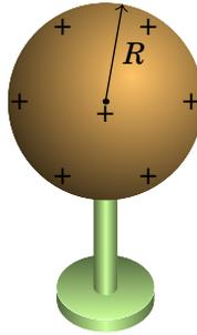
**Figura 4.4.:** Esfera condutora, de raio  $R$ , carregada e isolada.
