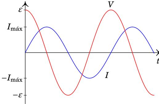
**Figura 10.2.:** Tensão e corrente no circuito LC representado na direita da figura 10.1.
