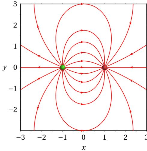
**Figura 1.15.:** Campo elétrico de um dipolo elétrico.
