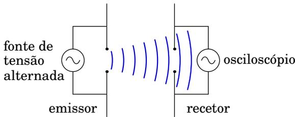
**Figura 12.6.:** Produção e detecção de uma onda eletromagnética.
