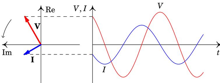
**Figura 10.7.:** Fasores da tensão e da corrente num condensador.
