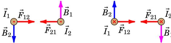
**Figura 8.14.:** Força magnética entre fios retilíneos e paralelos, com correntes no mesmo sentido.
