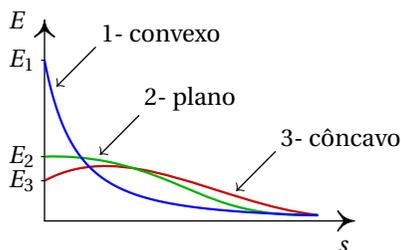
**Figura 3.15.:** Gráfico do módulo do campo elétrico em 3 partes diferentes da superfície de um condutor.
