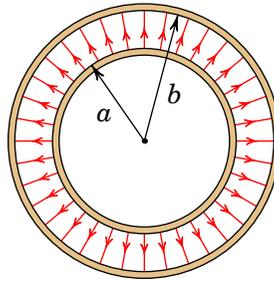
**Figura 4.12.:** Campo elétrico de um condensador esférico.
