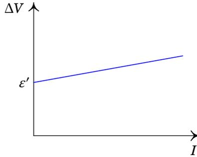
**Figura 12.12.:** Característica tensão-corrente de um LED.
