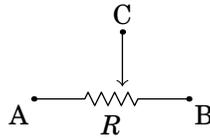
**Figura 6.11.:** Diagrama de circuito de um potenciómetro.
