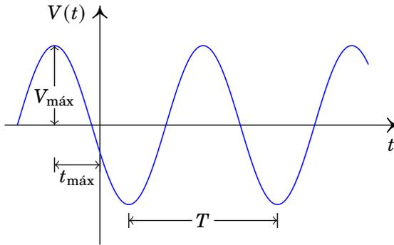
**Figura 10.3.:** Tensão alternada com período  $T$  e valor máximo  $V_{\text{máx}}$ .
