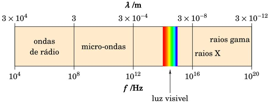
**Figura 12.7.:** Espectro eletromagnético.
