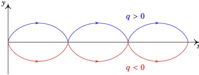
**Figura 7.8.:** Movimento a partir do repouso de uma carga pontual  $q$  numa região com campos elétrico e magnético uniformes e perpendiculares entre si ( $\vec{E}$  segundo  $y$  positivo e  $\vec{B}$  segundo  $z$  positivo).
