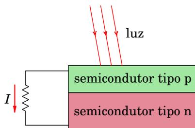
**Figura 12.8.:** Célula fotovoltaica.
