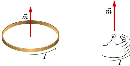
**Figura 7.12.:** Definição do momento magnético de uma espira.
