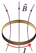
**Figura 9.6.:** Campo magnético produzido pela corrente numa bobina.
