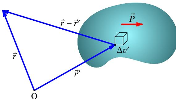
**Figura 4.7.:** Dielétrico com polarização  $\vec{P}$  dividido em pequenos elementos de volume  $\Delta v'$ .
