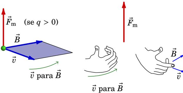
**Figura 7.2.:** Força magnética sobre uma carga pontual positiva.
