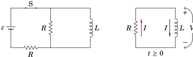
**Figura 9.9.:** Diagrama de um circuito RL em série.
