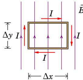
**Figura 7.11.:** Espira dentro de um campo magnético uniforme.
