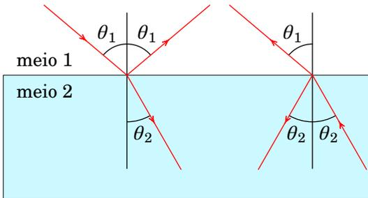
**Figura 12.1.:** Reflexão e refração de um raio de luz que passa de um meio para outro.
