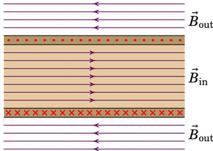
**Figura 8.12.:** Campo magnético num solenoide infinito, onde  $B_{in} = 4\pi k_m nI$  e  $B_{out} = 0$ .
