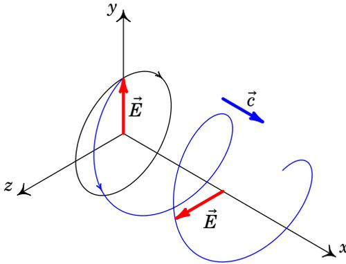
**Figura 11.5.:** Onda eletromagnética com polarização circular direita.
