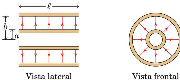
**Figura 4.13.:** Campo elétrico de um condensador cilíndrico.
