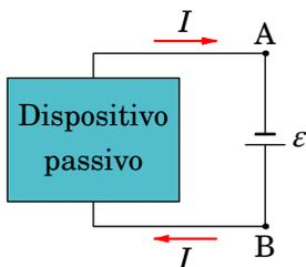
**Figura 5.7.:** Dispositivo passivo ligado a uma bateria ideal.
