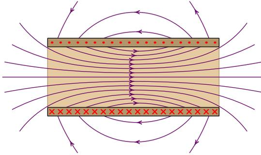
**Figura 8.11.:** Campo magnético produzido por um solenoide.
