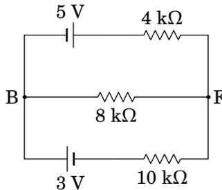
**Figura 6.3.:** Circuito equivalente ao circuito da figura 6.2.
