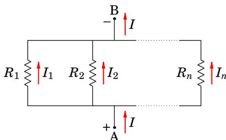
**Figura 6.10.:** Divisão de corrente entre várias resistências.
