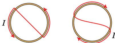
**Figura 8.8.:** Regra para identificar os polos de uma bobina com corrente.
