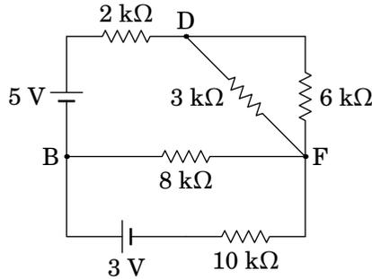
**Figura 6.2.:** Circuito equivalente ao circuito da figura 6.1.
