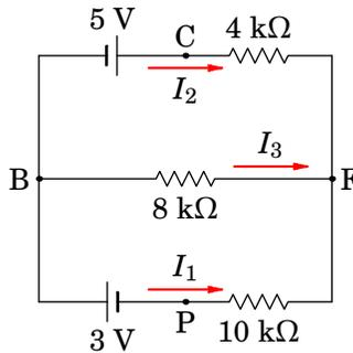
**Figura 6.5.:** Circuito com dois nós e três malhas.
