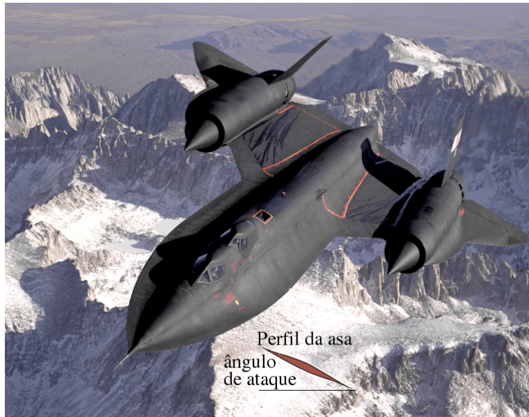
Figura 5: Um avião supersônico tem asas com um perfil mais fino e mais simétrico do que nos aviões comerciais.
