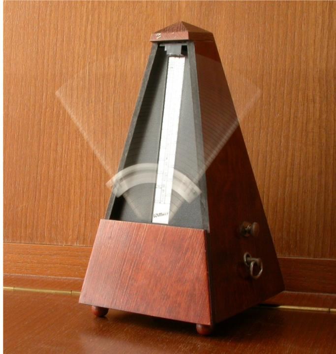
O metrônomo produz pulsos de duração regular que podem ser ajustados deslocando um peso na haste que oscila. Os osciladores têm tido um papel muito importante no desenvolvimento da teoria dos sistemas dinâmicos.
