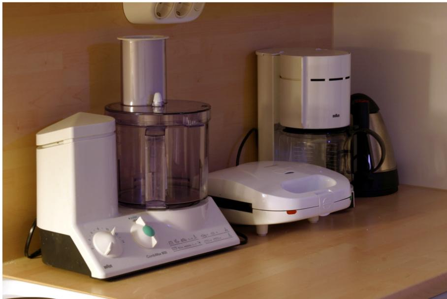
**Figura 3.3.:** A resistência de cada eletrodoméstico é igual ao quadrado da diferença de potencial à qual deverá ser ligado, dividido pela sua potência nominal.
