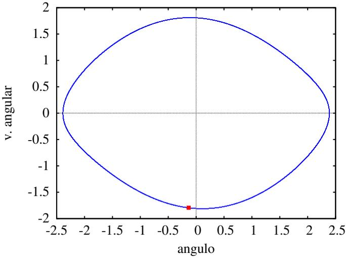
**Figura 12.7.:** Ciclo limite quando  $C_2 = 0.8$ .
