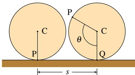
**Figura 3.11.:** Roda que se desloca rodando sem derrapar.
