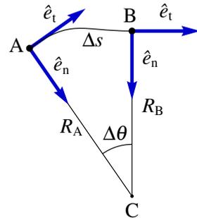
**Figura 3.5.:** Raio de curvatura.
