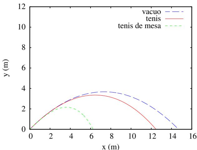
**Figura 10.8.:** Trajetórias de uma bola no vácuo e bolas de tênis e tênis de mesa no ar.
