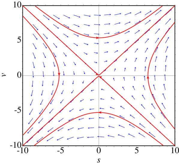
**Figura 9.10.:** Retrato de fase do oscilador invertido.
